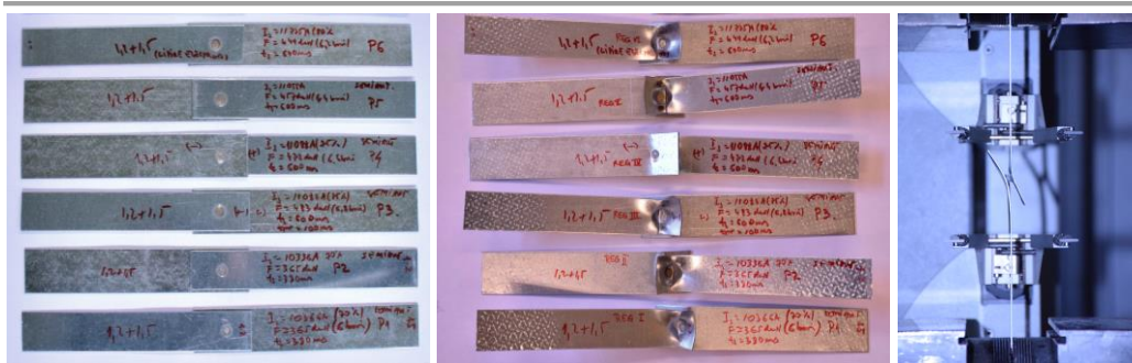
Fig. 3 – Setul de specimene SW-1.2-1.5 înainte de încercare și după încercare, analizând diferite regimuri de sudare
