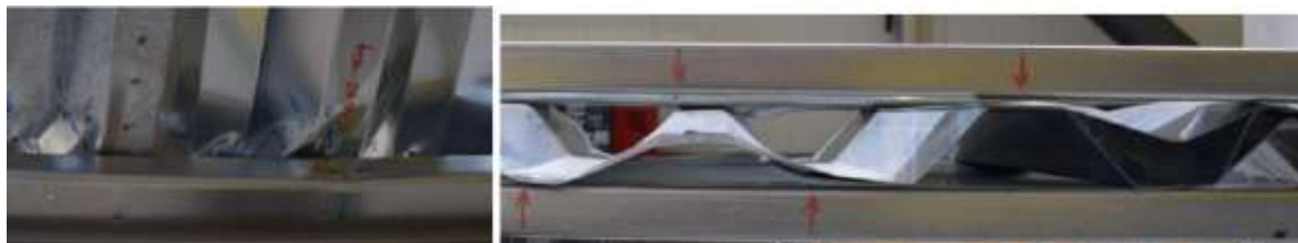
Figura 21: Distorsiunea cutelor inimii pentru grinda CWB SW-2.
