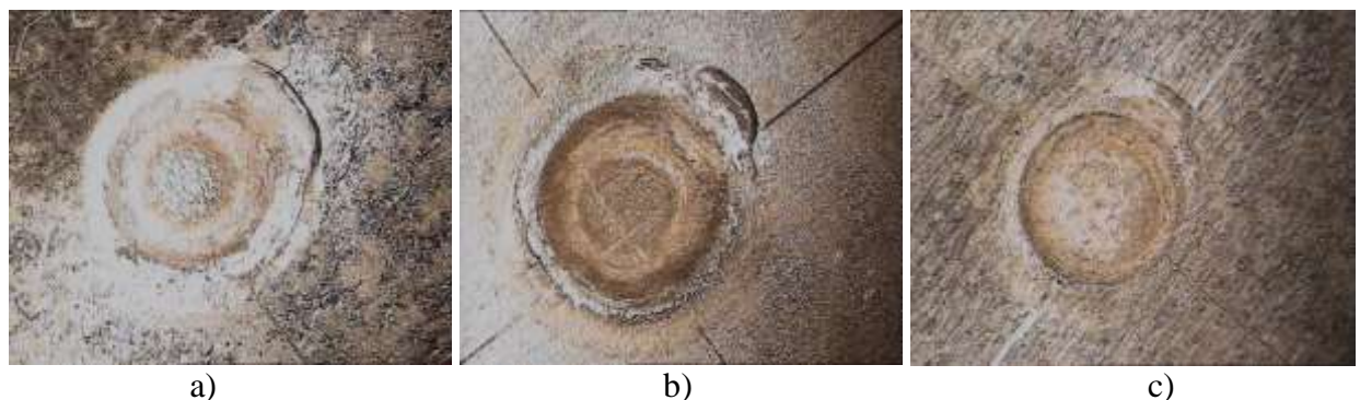
Fig. 4.1. Punct sudat, MS x1 Planul de prelevare a probelor metalografice: a) table 1,5-1,5; b) table 2,0-2,0; c) table 1,2-1,2
