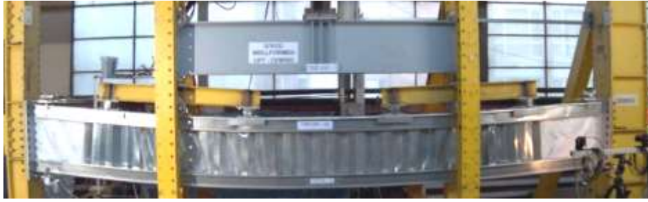
Figure 15: Grinda CWB-SW1 – deformația globală în timpul testării.
