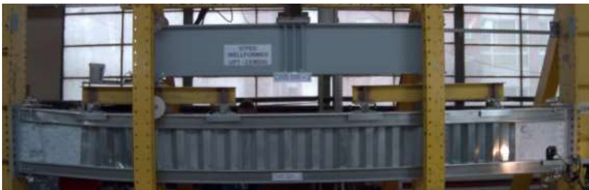
Figura 19: Grinda CWB SW-2 – Deformarea globală în timpul testului.
