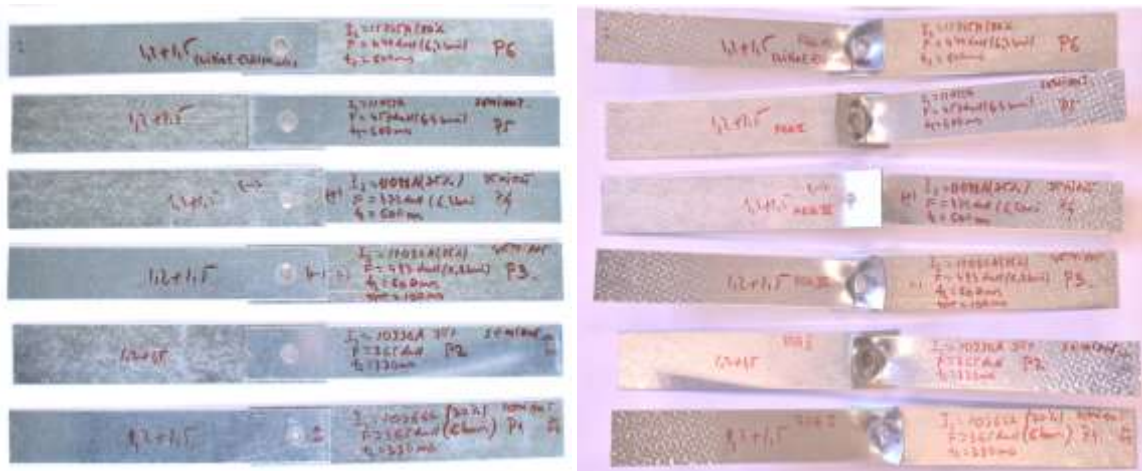
Figura 3: Epruvete SW-1.2-1.5 înainte și după încercare, utilizând diferite regimuri de sudare.
