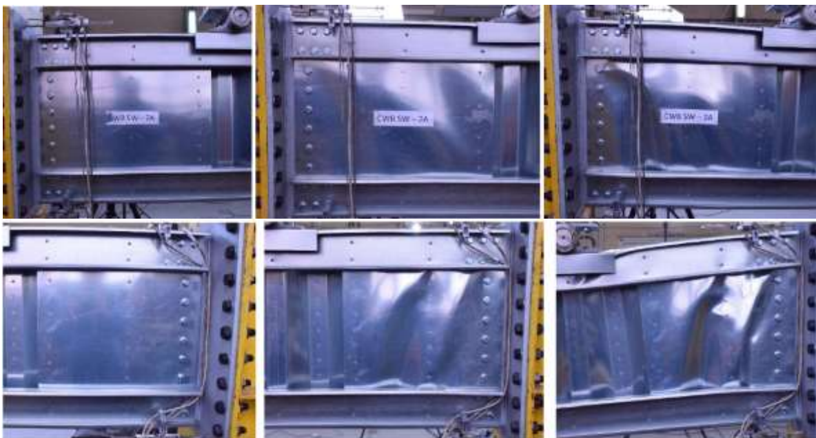
Figura 20: Dezvoltarea voalării datorată forfecării, a panourilor de forfecare de la capetele grinzii CWB SW-2.
