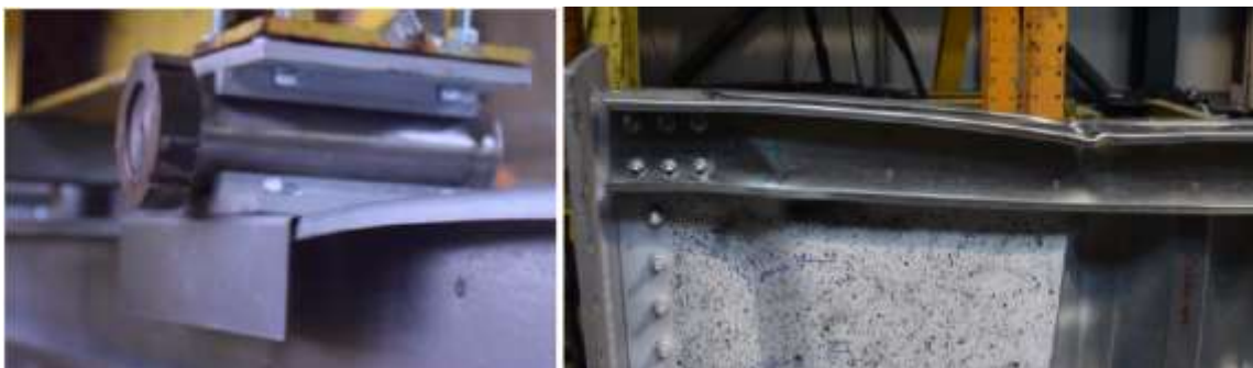
Figura 24: Deformații locale în punctele de aplicare a încărcării.
