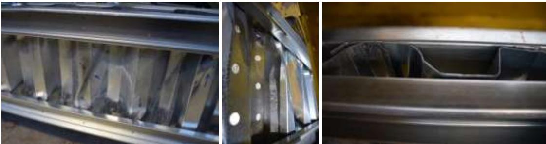
Figure 17. Distorsiunea cutelor inimii grinzii CWB SW-1.
