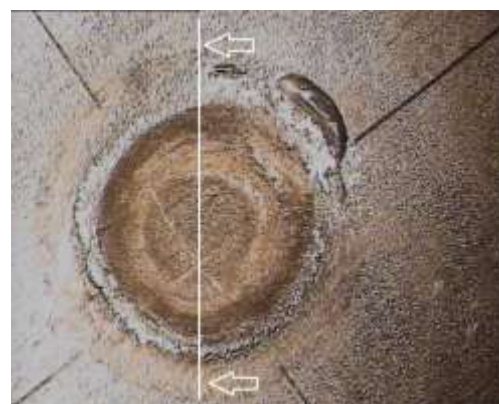
Fig. 4.3. Planul de prelevare a probelor metalografice
