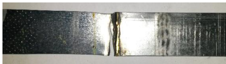
Fig. 9. Cedarea epruvetelor sudate prin brazare MIG
