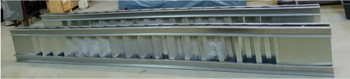
Fig. 24. Grinda cu inimă cutată SW1 înainte de încercare
